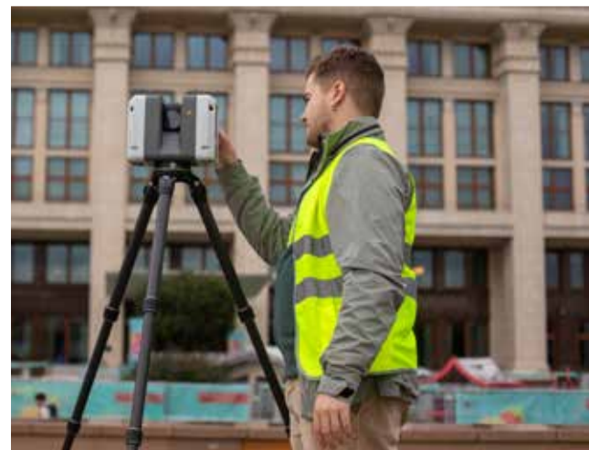
Лазерное сканирование фасада здания гостиницы «Четыре сезона»
